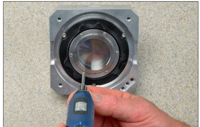
Montage d'un ECI 119
